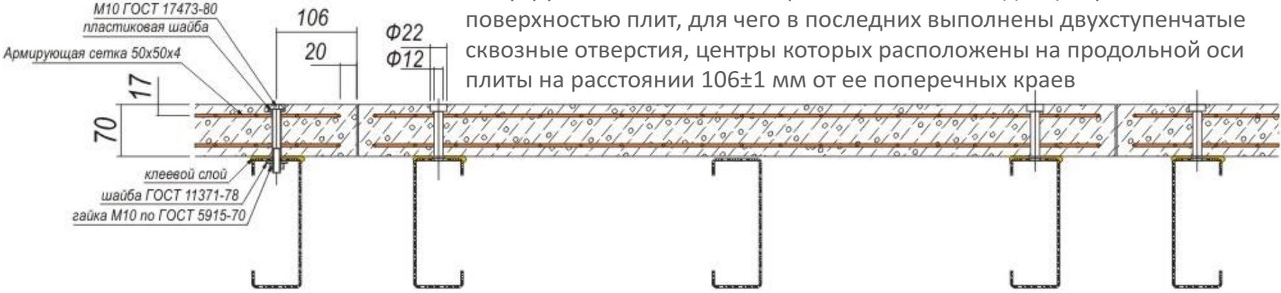
С учетом предусмотренной проектом возможности регулировки вертикального и горизонтального положения платформы верхние площадки лестниц и пандусов также являются регулируемыми по высоте и перемещаемыми перпендикулярно оси пути. Конструктивные решения, механизм и диапазон перемещений верхних площадок и самой платформы - идентичны. За исключением верхних площадок, все остальные конструкции лестниц и пандусов, являются стационарными.
