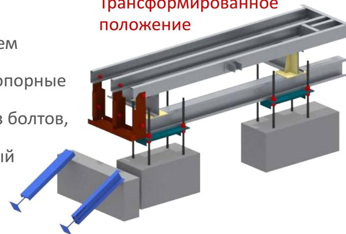
Перед проведением путевых работ дополнительные опорные стойки удаляются, снимается один из болтов, соединяющих трансформируемый элемент балки со стационарным, и край платформы переводится в вертикальное положение
