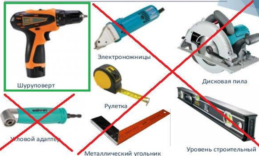
Инструменты для монтажа и подрезки элементов ЛСТК
