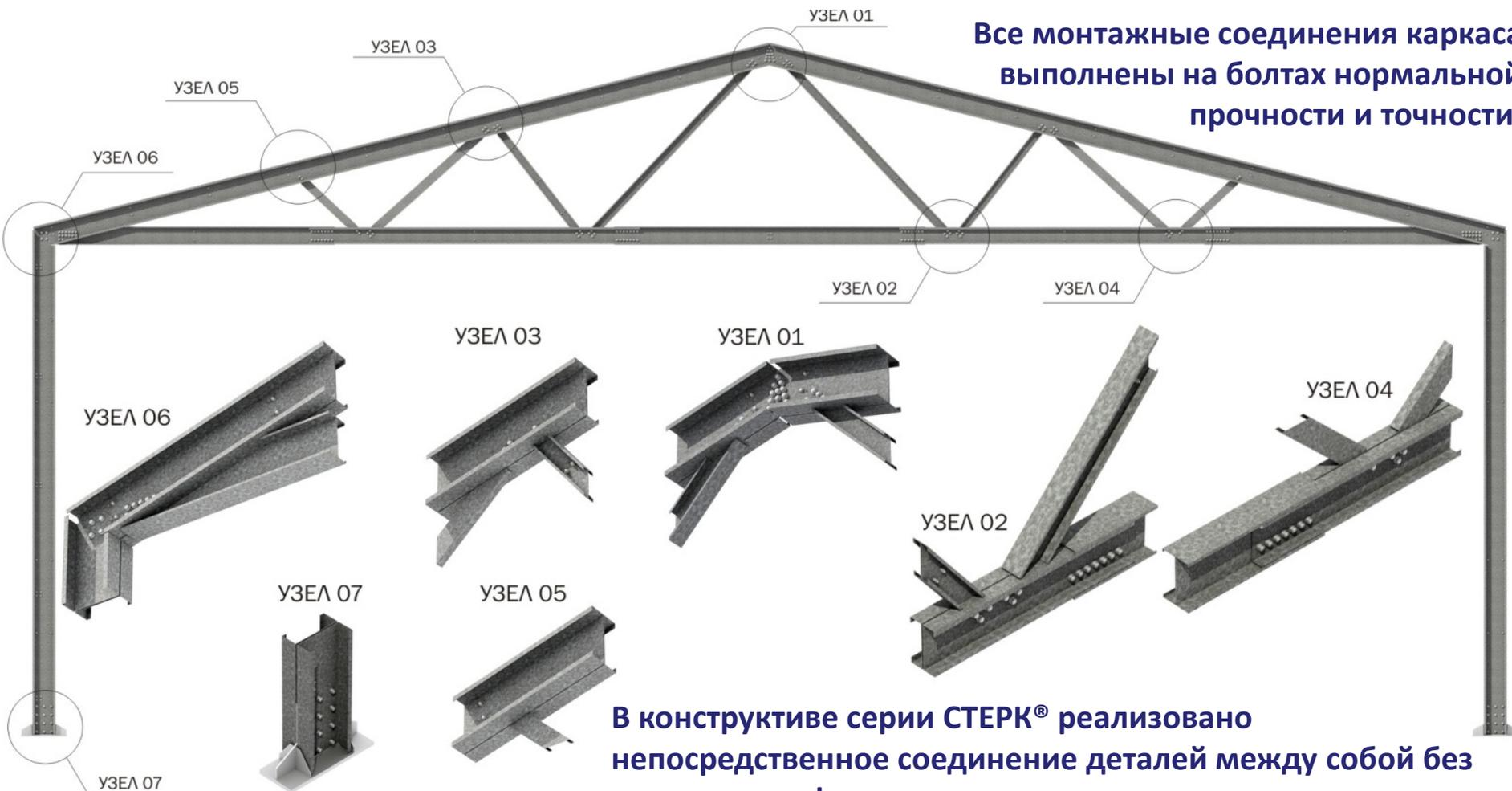
**В конструктиве серии СТЕРК® реализовано непосредственное соединение деталей между собой без применения фасонных элементов.**
