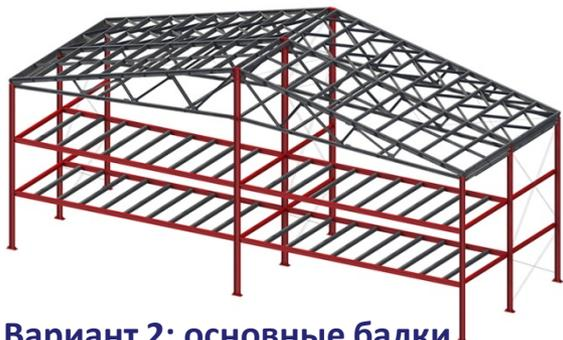
Вариант 2: основные балки перекрытия – из двутавров; второстепенные - из холодногнутых профилей.
