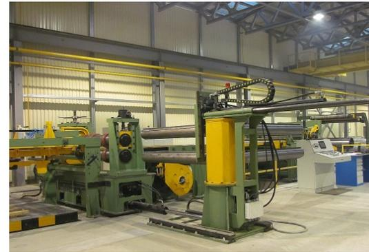
Оборудование по изготовлению полосы любой ширины для оцинкованной стали толщиной до 4мм включительно из рулонов весом до 15 тонн.
