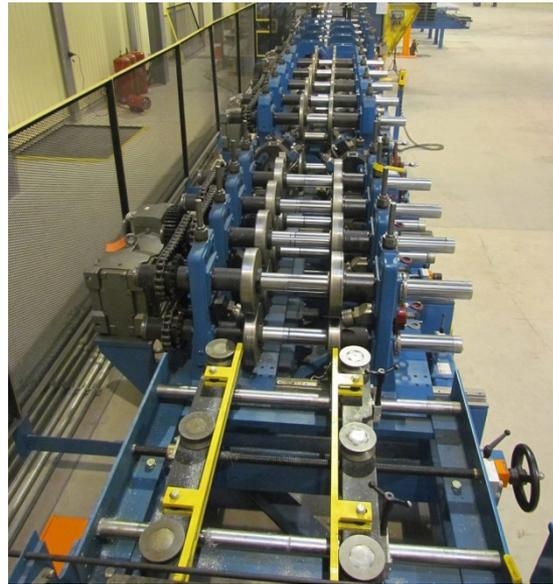
Машинный комплекс для производства холодногнутого профиля различного сечения (С,  $\Sigma$ , Z, швеллер, уголок и т.д.) высотой до 400 мм и толщиной до 3,5мм.
