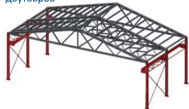
Вариант 1: балки перекрытия из двутавров
