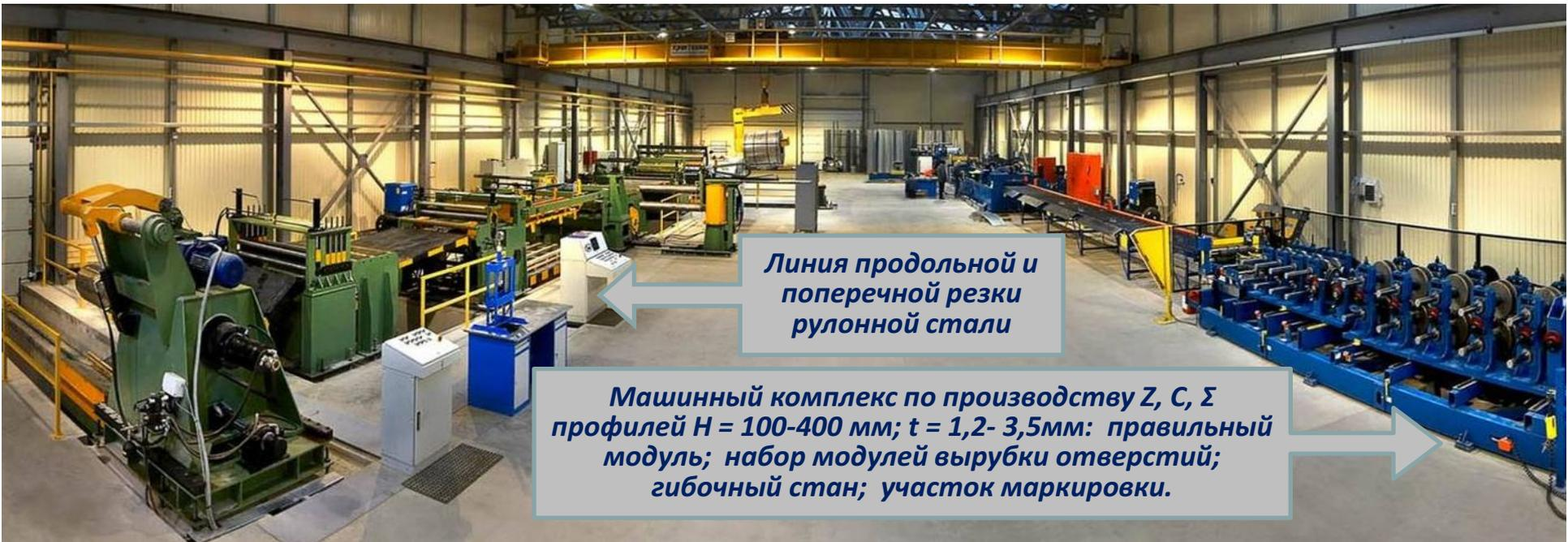
*Линия продольной и поперечной резки рулонной стали*
