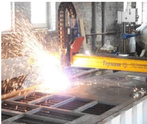
Плазменная резка Цифровое управление. Толщина листа: 5 – 35 мм.
