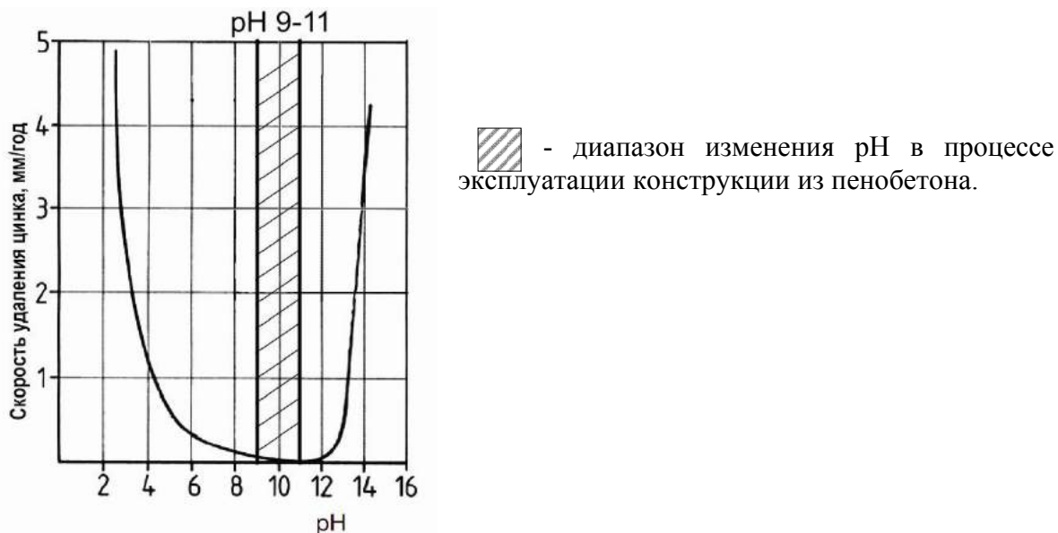
Рисунок 4.4 – Степень стойкости цинкового покрытия в зависимости от pH
