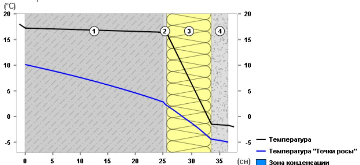
Термическое сопротивление ограждающей конструкции 2.85
