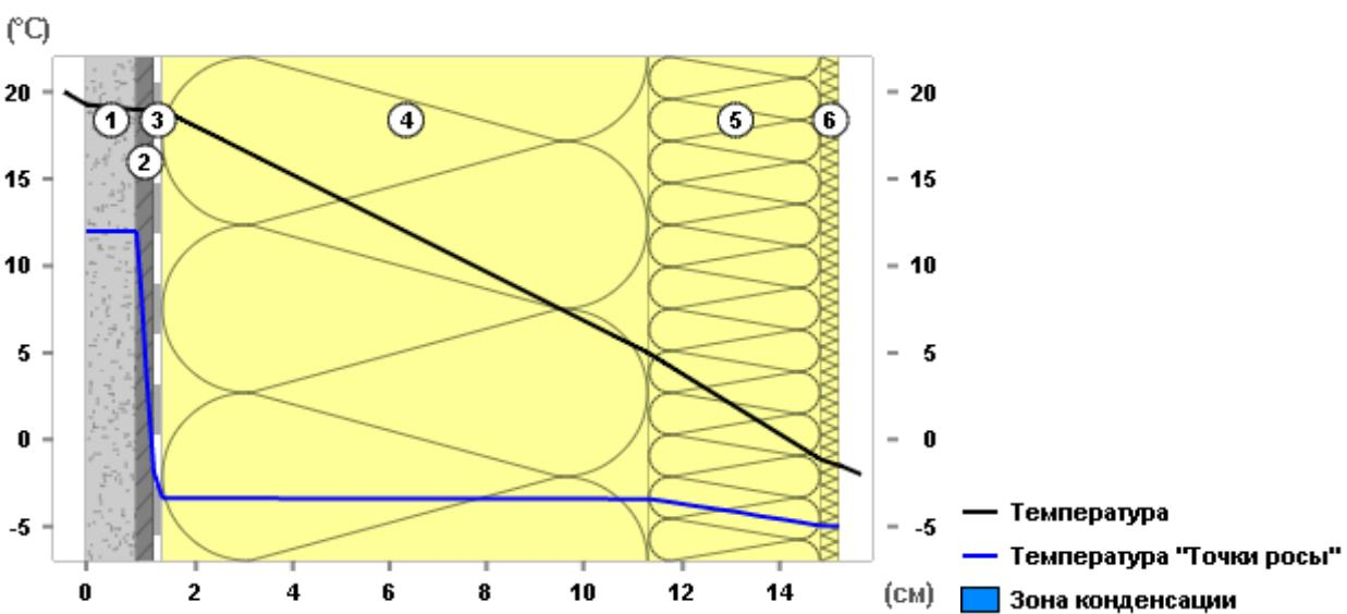
Термическое сопротивление ограждающей конструкции 3,29
