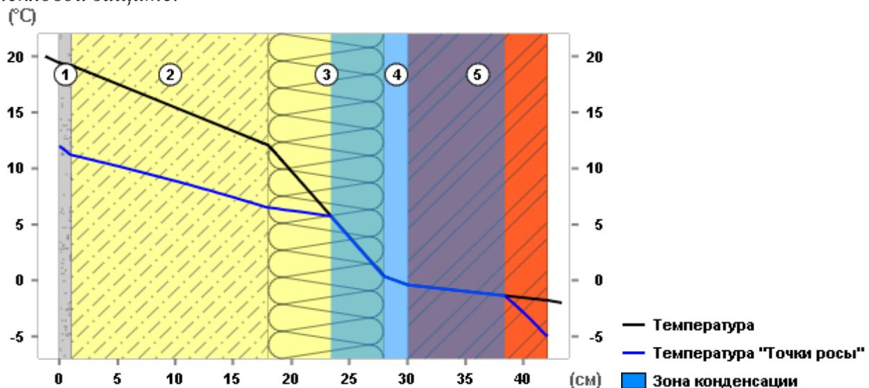
Термическое сопротивление ограждающей конструкции  $4,21$
