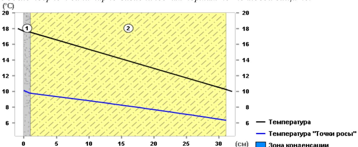
Термическое сопротивление ограждающей конструкции 2,55
