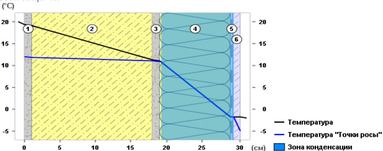
Термическое сопротивление ограждающей конструкции 3,84
