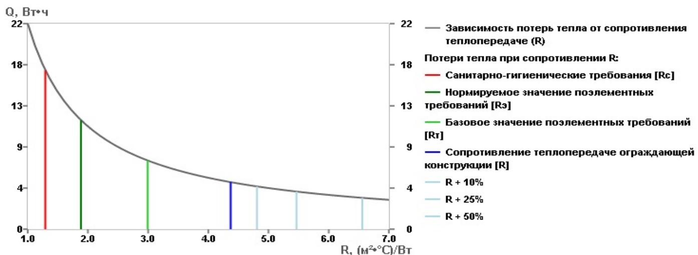
Потери тепла за отопительный сезон: **24.99**  $\text{кВт}\cdot\text{ч}$
